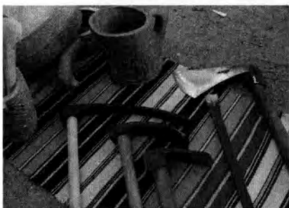
عکس ۲۲. برخی ابزارهای چوتاشی به ترتیب از راست به چپ: تور، رخ کن، تاشه و ول تاشه کوتاه و بلند
